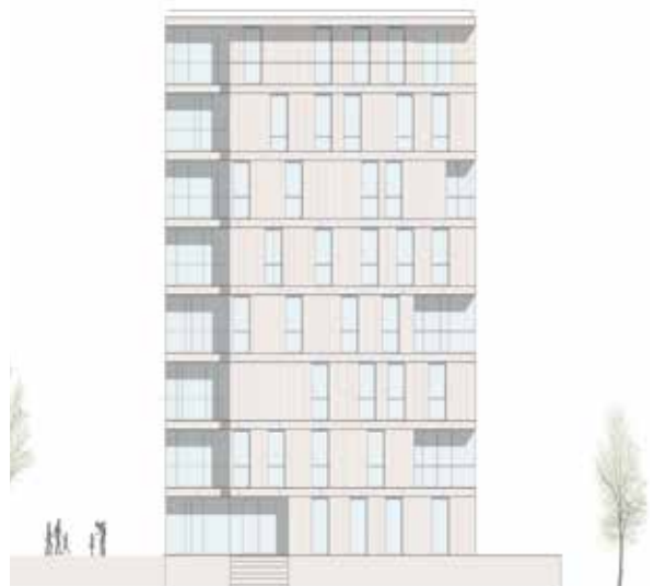
Ansicht Baufeld 4: 8-geschossiges Gebäude in Holzmodulbau
